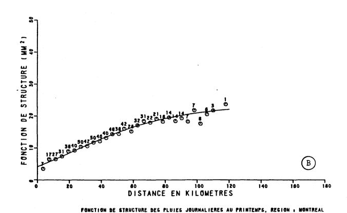
Figure 5.7. Points initiaux, points moyens par classe de distance et courbe ajustée.
