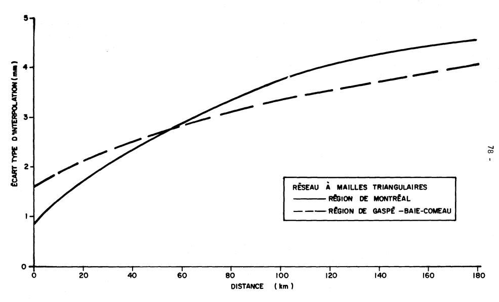
Figure 5.10. Écart type d'interpolation en fonction de la distance entre les stations pour les pluies journalières au printemps.
