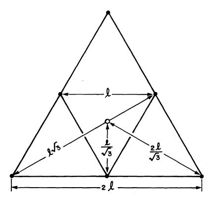
Figure 5.9. Position des stations pour le calcul de l'erreur d'interpolation au centre de deux triangles équilatéraux emboîtés.
