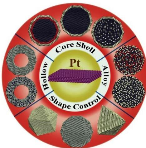
**Figure R5.** Les avancées importantes récentes dans les nouvelles nanostructures actives et durables à base de Pt pour une meilleure catalyse d'ORR.
