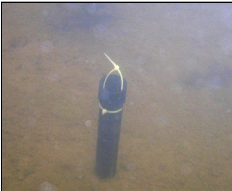
**Figure 2 : Système d'ancrage du capteur de pression submersible**
