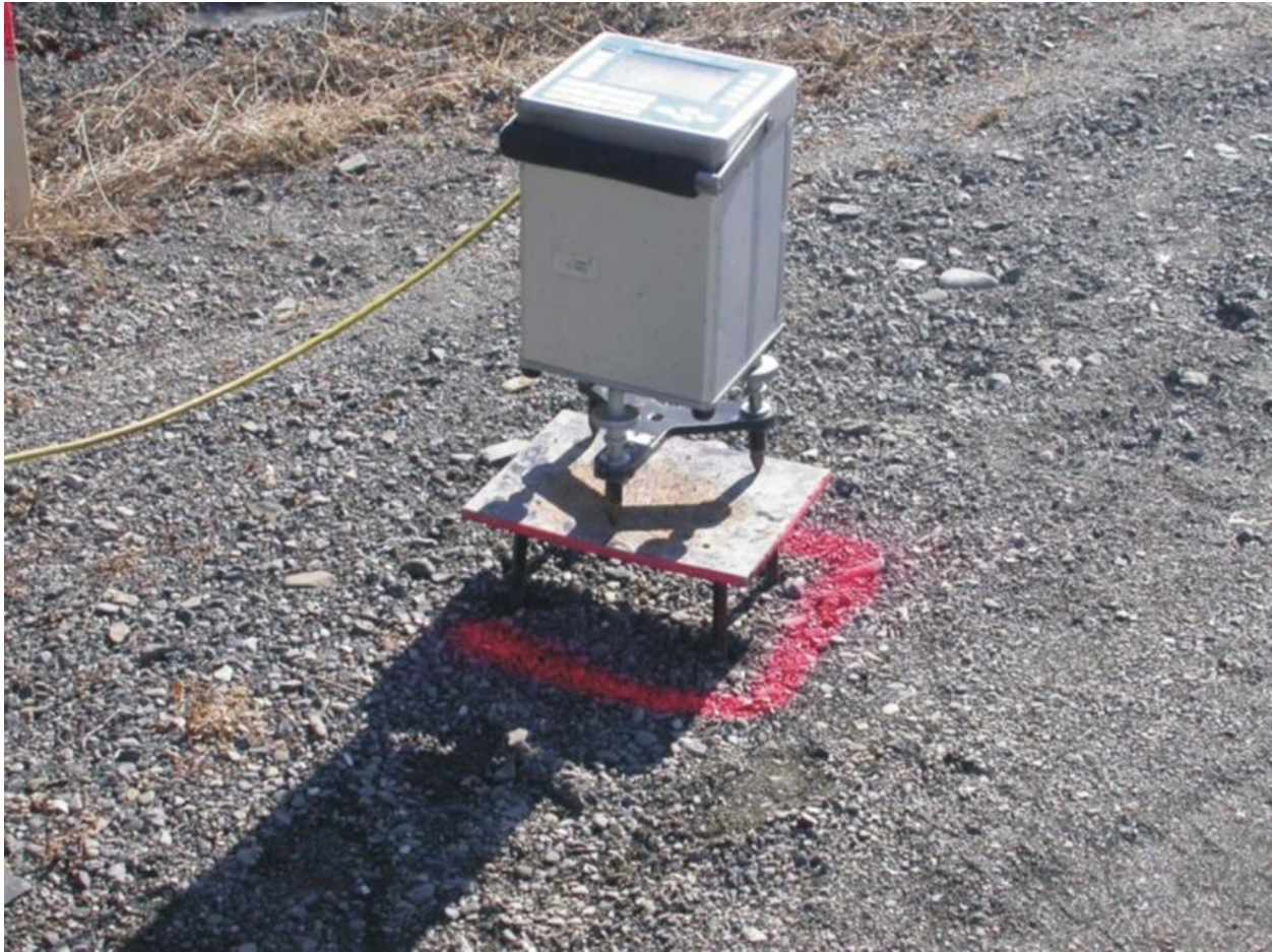
Figure 7-11: Gravimètre CG5 (Scintrex) utilisé lors du levé gravimétrique de Belleterre. Photo tirée de Lafèche (2014).
