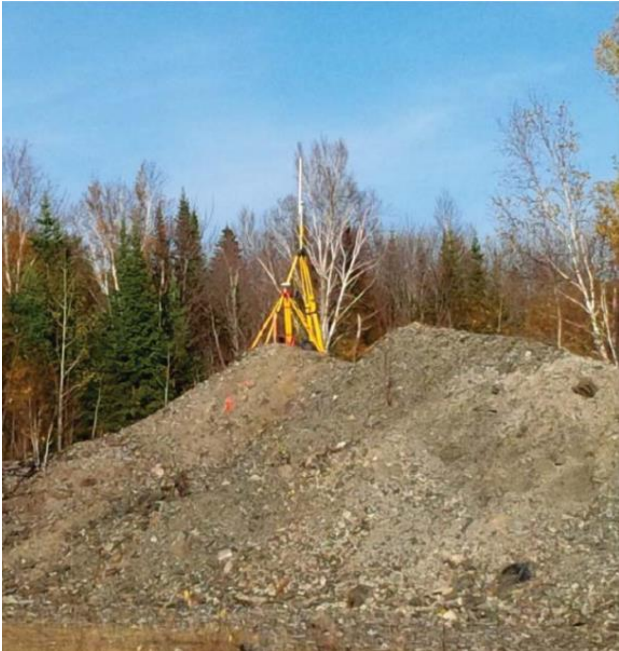
Figure 7-15: Station de base RTK située sur le monticule de minerai de la zone Aubelle principale. Photo tirée de Lafèche (2014).
