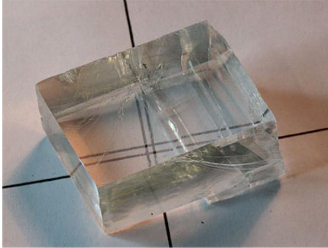
FIGURE 2.2 – Double réfraction à travers un cristal de calcite, image tirée de [48]
