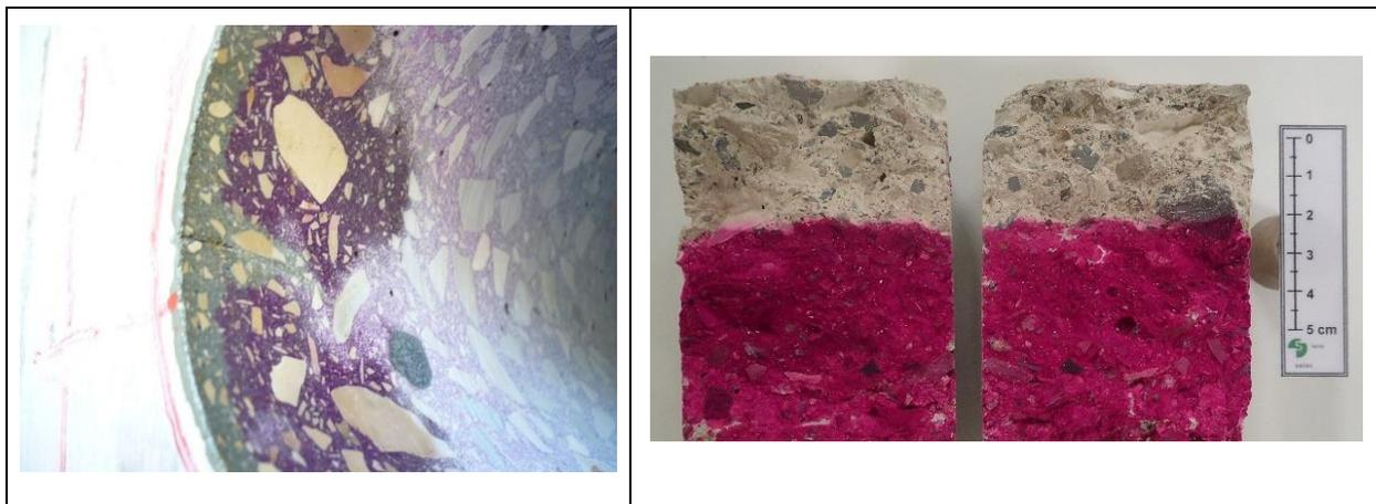
**Figure 2.20** Mesure de la profondeur de carbonatation sur site (à gauche) et en laboratoire (à droite). La zone carbonatée est incolore, la zone non carbonatée colorée en rose (Crédit SETEC).
