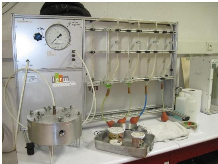
**Figure 2.19** Appareillage permettant de mesurer la perméabilité aux gaz (Crédit SETEC).
