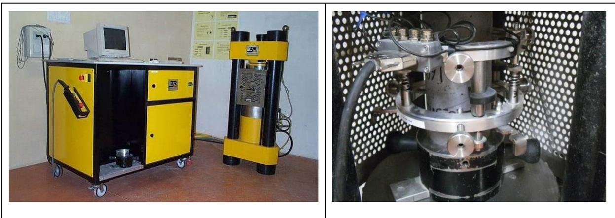
**Figure 2.17** Vue d'une presse de compression (gauche) et d'un système de mesure des déformations pour la détermination du module d'élasticité (droite) (Crédit SETEC).
