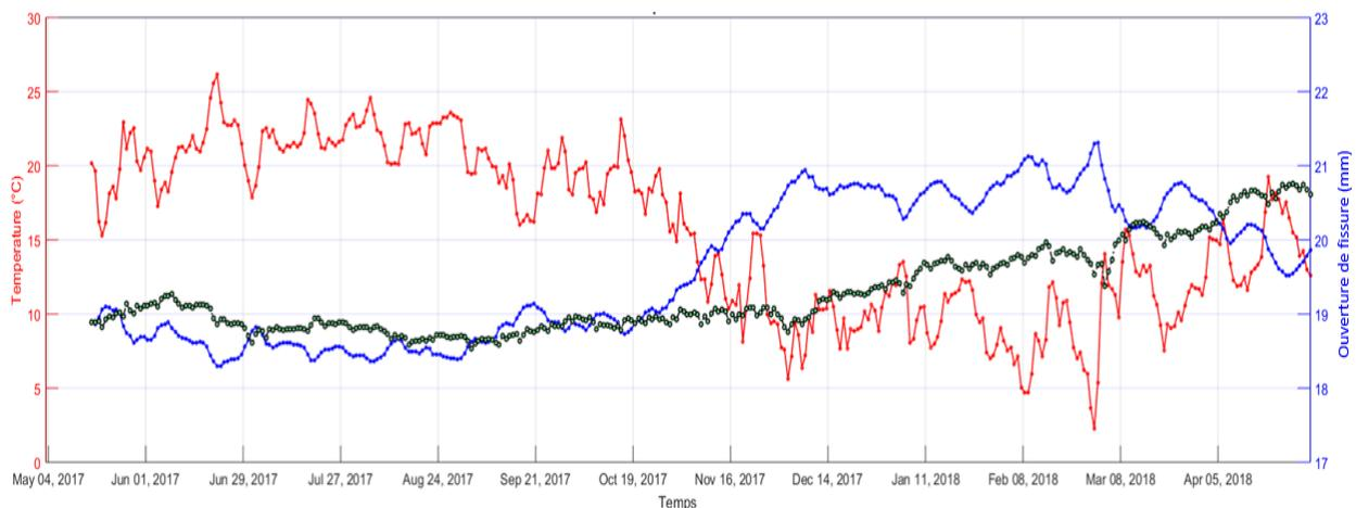
**Figure 3.1** Évolution de l'ouverture d'une fissure avant (en bleu) et après (en noir) correction de l'influence de la température (en rouge).
