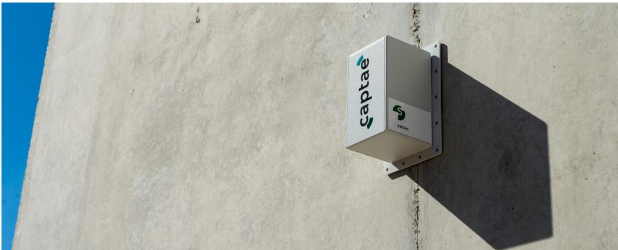
Figure 2.15 Capteur de *monitoring* multi-paramètres CAPTAE® implanté sur un ouvrage en béton armé (Crédit SETEC).
