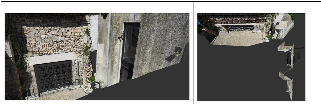
**Figure 2.25** Restitution numérique d'un ouvrage en maçonnerie et d'un mur en béton armé (gauche : vue de face - droite : vue de dessus) (Crédit SETEC).
