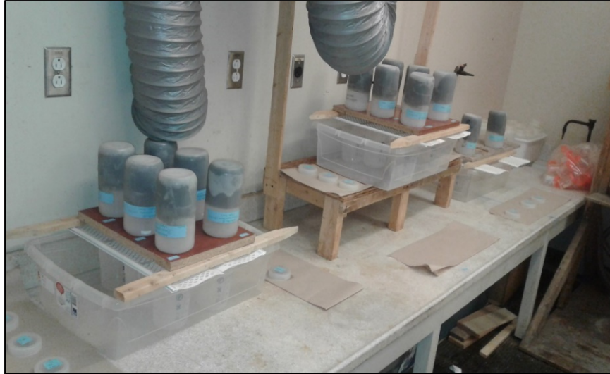
Figure 3.2 Photographie montrant la procédure de dégel et d'égouttement des boues d'épuration
