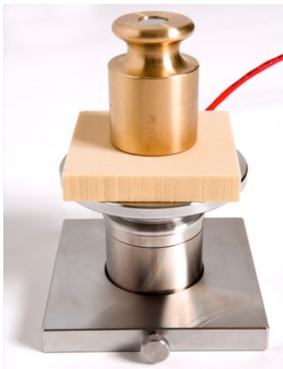
Figure 28. Schéma explicatif pour analyse de la conductivité thermique avec la méthode de la plaque chauffante transitoire (C-Therm technologies, 2016).
