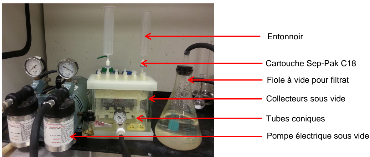
Figure 1-14. Dispositif extraction de l'atrazine et ses sous-produits de l'eau réelle de surface
