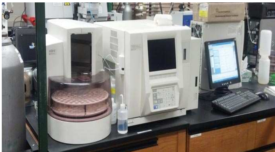
Figure 1-22. Shimadzu TOC 5000A utilisé pour les mesures du TOC et DOC
