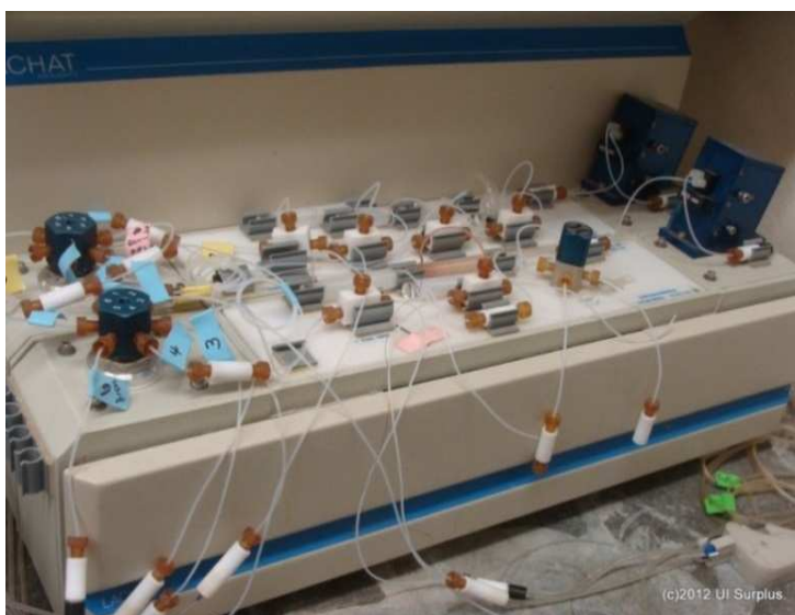
Figure 1-23. LACHAT Instrument utilisé pour la mesure de l'azote ammoniacal
