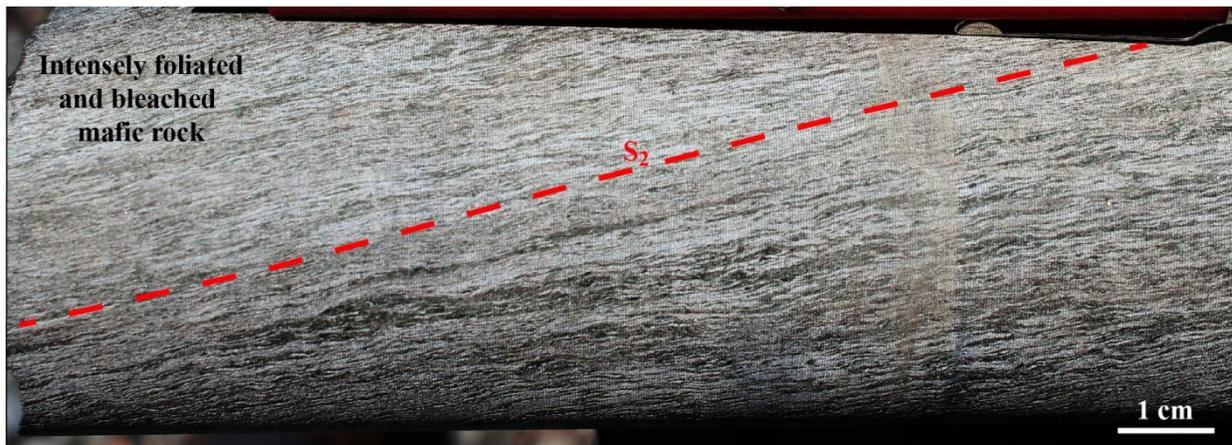
**Figure 12 : Carotte de roche volcanique mafique, unité « Basement basalts », forage 10-SIF-003, 136,5-139 m.**
