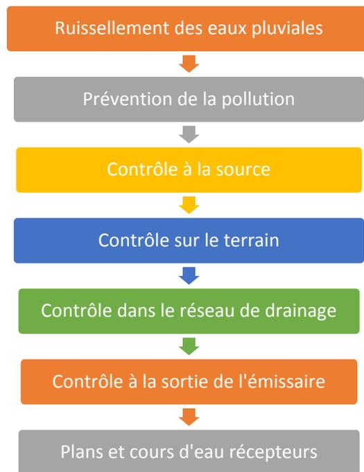
Figure 1: Processus de contrôle pour la gestion des eaux pluviales (adapté de *InfraGuide*, 2003; Ontario Ministry of the Environmental, 2003; Rivard, 2009)
