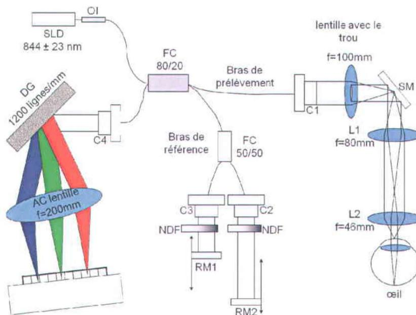
Figure 5. Schéma du système optique conçu pour mesurer les mouvements cornéens et rétiniens simultanément.
