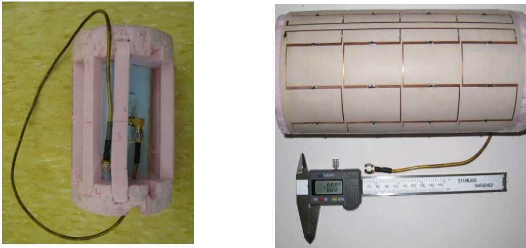
Fig. 8-14 Photo de l'antenne reconfigurable à faisceau commuté fabriquée.
