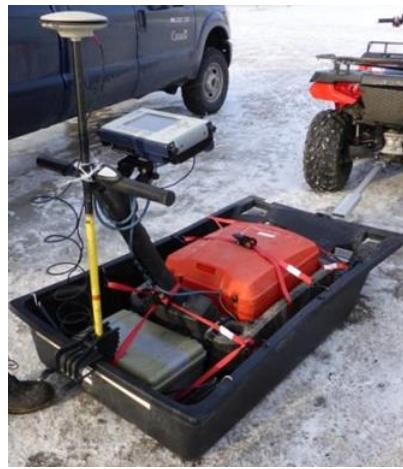
**Figure 2.3 Géoradar (GSSI SIR-3000) mesurant la constante diélectrique.**
