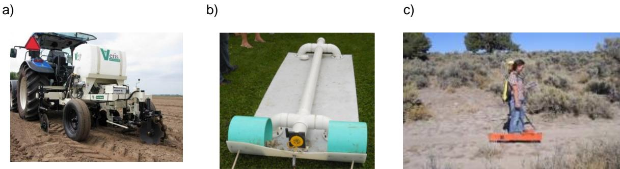
**Figure 2.2 Capteurs proximaux a) VERIS-MSP3, b) DUALEM-21S, c) EM38, mesurant en continu la conductivité électrique apparente.**
