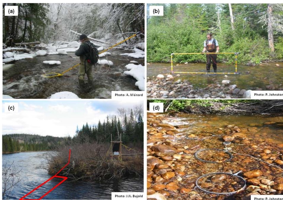
Figure 2. Différents types d'antennes à transpondeurs passifs : (a) antenne portable typique, (b) antenne portable grand format, (c) antenne fixe transversale et (d) système d'antennes fixes multiples avant enfouissement sous le substrat.
