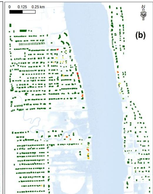
**Figure 4-9** Domages estimés (à gauche) et leur incertitude (à droite) pour le secteur d'étude pour des débits de 1539 m<sup>3</sup>/s (a) et de 1113 m<sup>3</sup>/s (b).
