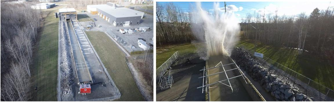
FIGURE 1.2: Vue d'ensemble du canal, incluant un instantané d'impact de vague sur le mur.
