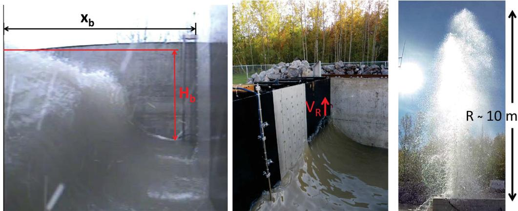
FIGURE 1.4: Définition des variables associées au déferlement de la vague et au jet près du mur.
