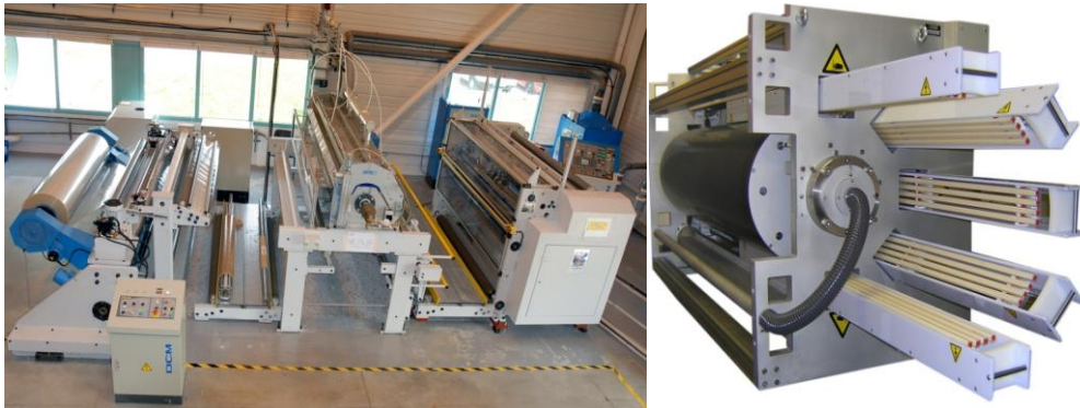
Figure I-10 : Réacteur de traitement type Roll-to-roll industriel. La décharge électrique se produit entre les barreaux recouverts de diélectrique et le rouleau qui entraîne le film
