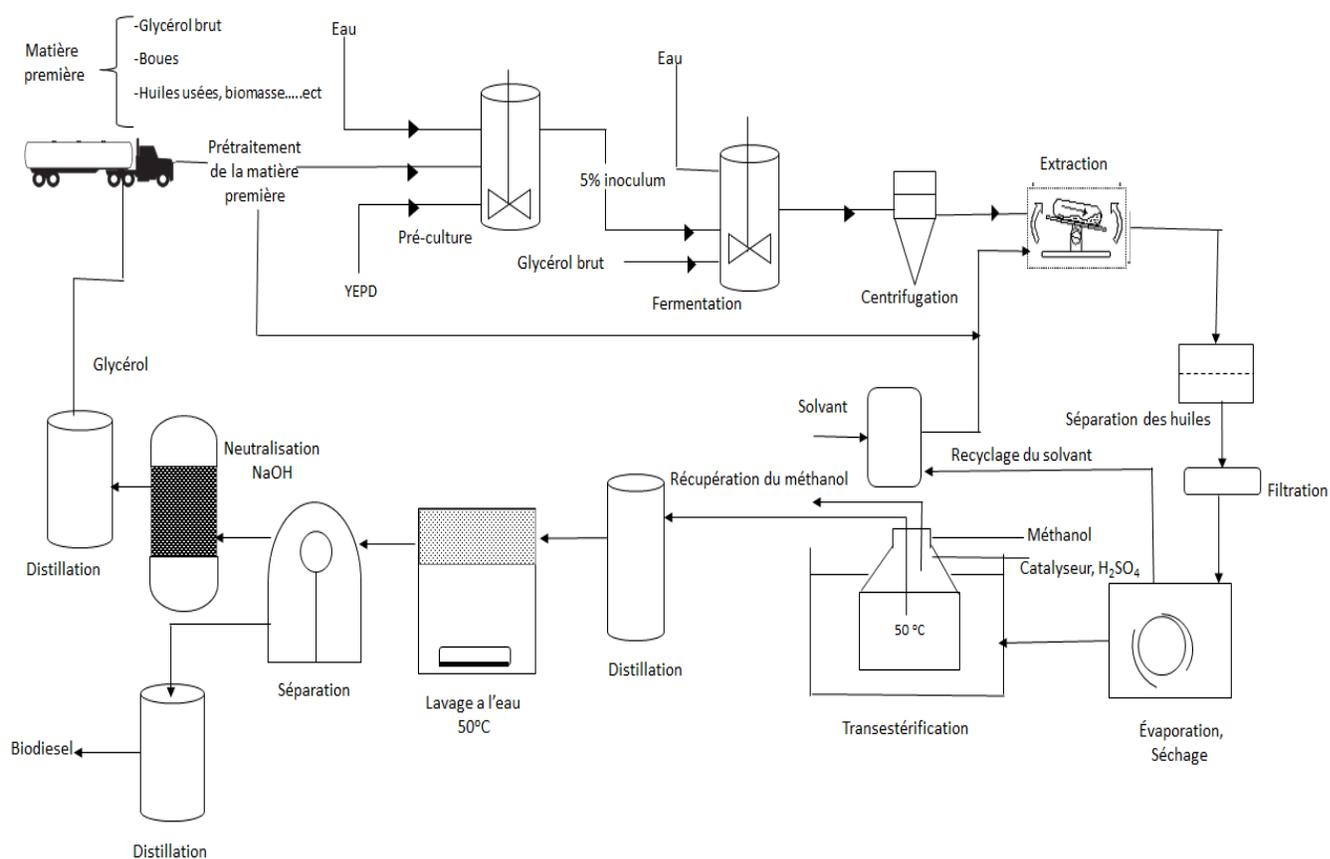
**Figure 1.2 Processus de production de biodiesel**
