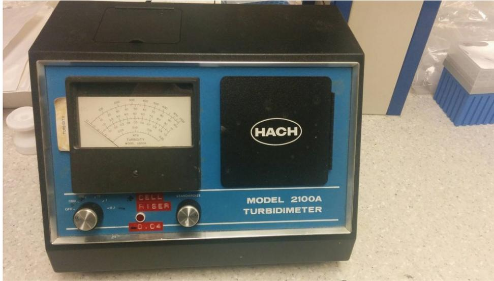
**Figure 10** Turbidimètre Hach modèle 2100A
