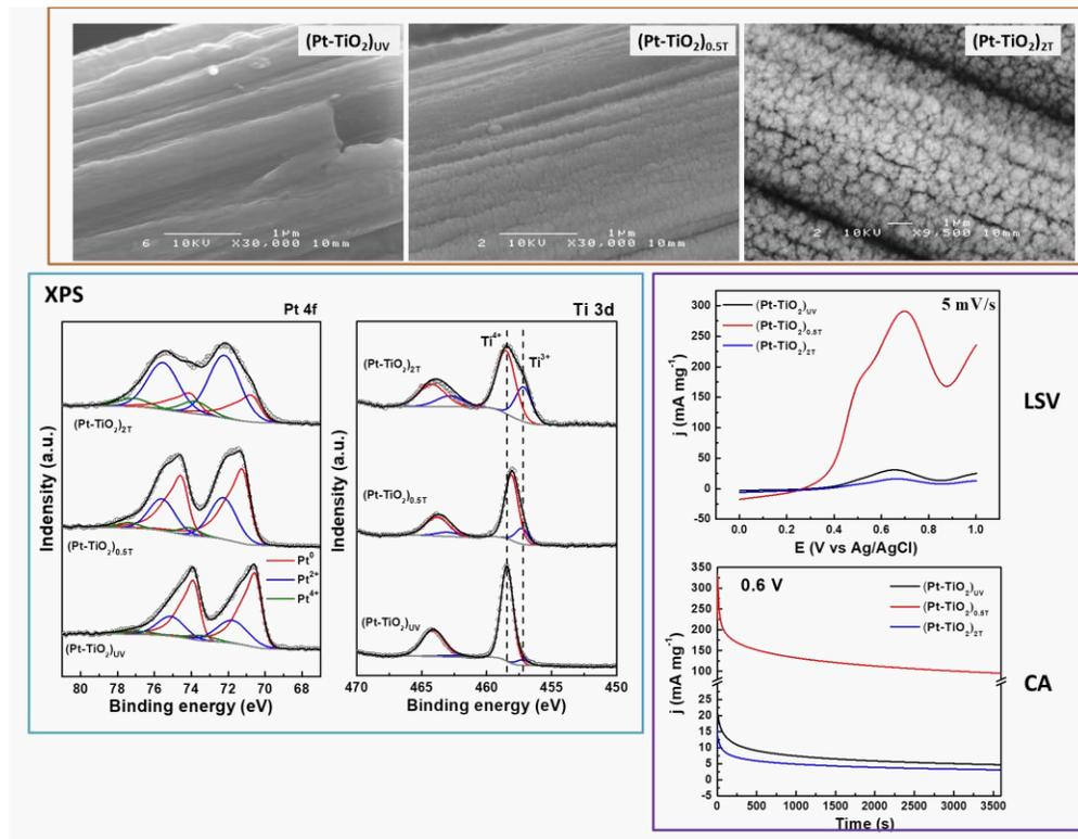
Figure R3 Images SEM, Spectres XPS des niveaux de cœur Pt 4f et Ti 3d, et LSV, CA en solutions de 0.5 M H<sub>2</sub>SO<sub>4</sub>+1.0 M EtOH.
