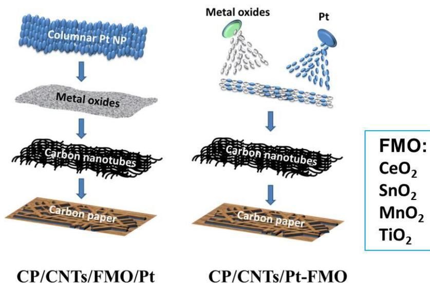
**Figure R1** La représentation de deux architectures de film de catalyseur contenant Pt et FMO: l'architecture couche sur couche (gauche), l'architecture co-déposée (droite).
