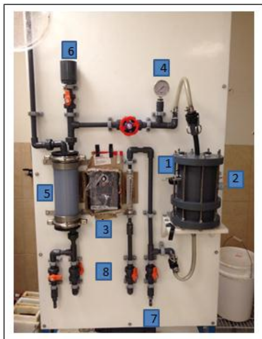
Figure 5.3 Structure schématique de la cellule cylindrique
