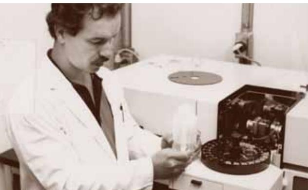
Appareil d'absorption atomique équipé d'un four au graphite
