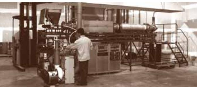
Usine pilote pour le traitement de sédiments contaminés
