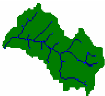
Figure A3.21 : Réseau hydrographique correspondant au seuil pour le bassin BARON FORK (465 m)
