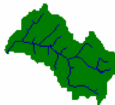
Figure A3.22 : Réseau hydrographique correspondant au seuil pour le bassin BARON FORK (465 m)
