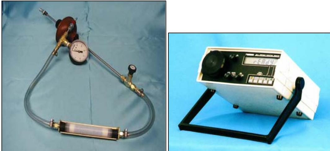
Figure 6. A) Sonde à gaz qui sera enfoncée dans le sol (à gauche) et B) analyseur portable (à droite).
