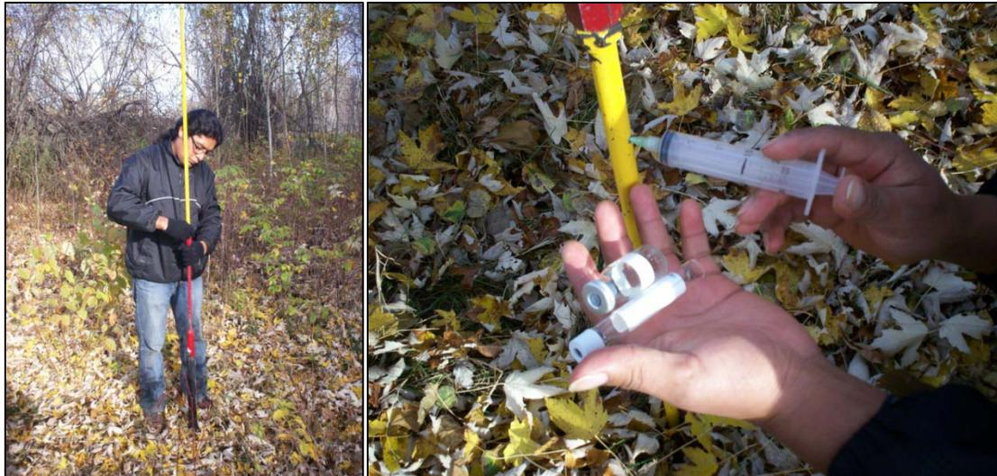
Figure 4. Sonde à gaz (à gauche) et prélèvement du gaz à l'aide de la seringue qui sera injecté dans les deux fioles présentées (à droite).
