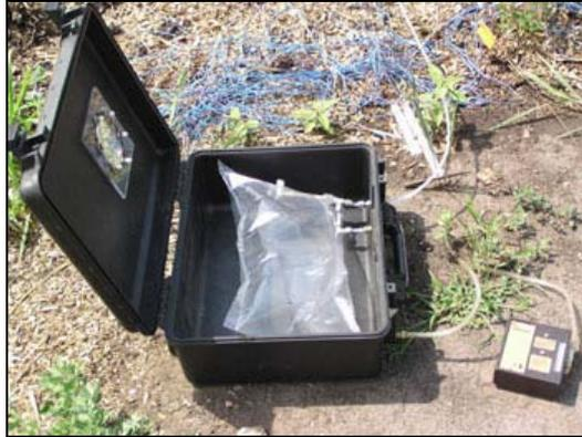
Figure 3. Échantillonnage du gaz servant à l'analyse des concentrations en  $\text{CO}_2$  et des ratios isotopiques  $^{13}\text{C}/^{12}\text{C}$  à la surface du sol à l'aide de sac en Tedlar et d'une pompe.
