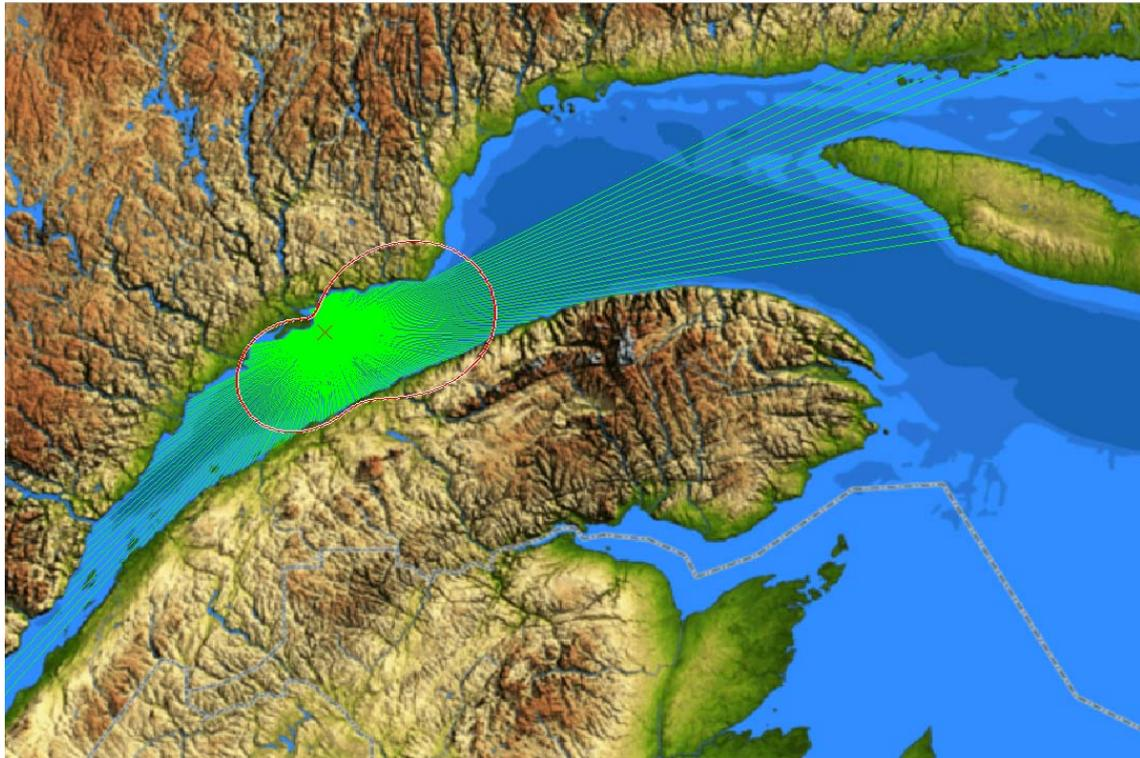
Figure 2: Point focal, radiales et longueur du fetch effectif
