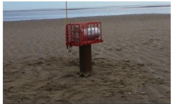
Figure 36 : Capteur de pression installé à l'été 2001 sur l'estran de la péninsule de Manicouagan
