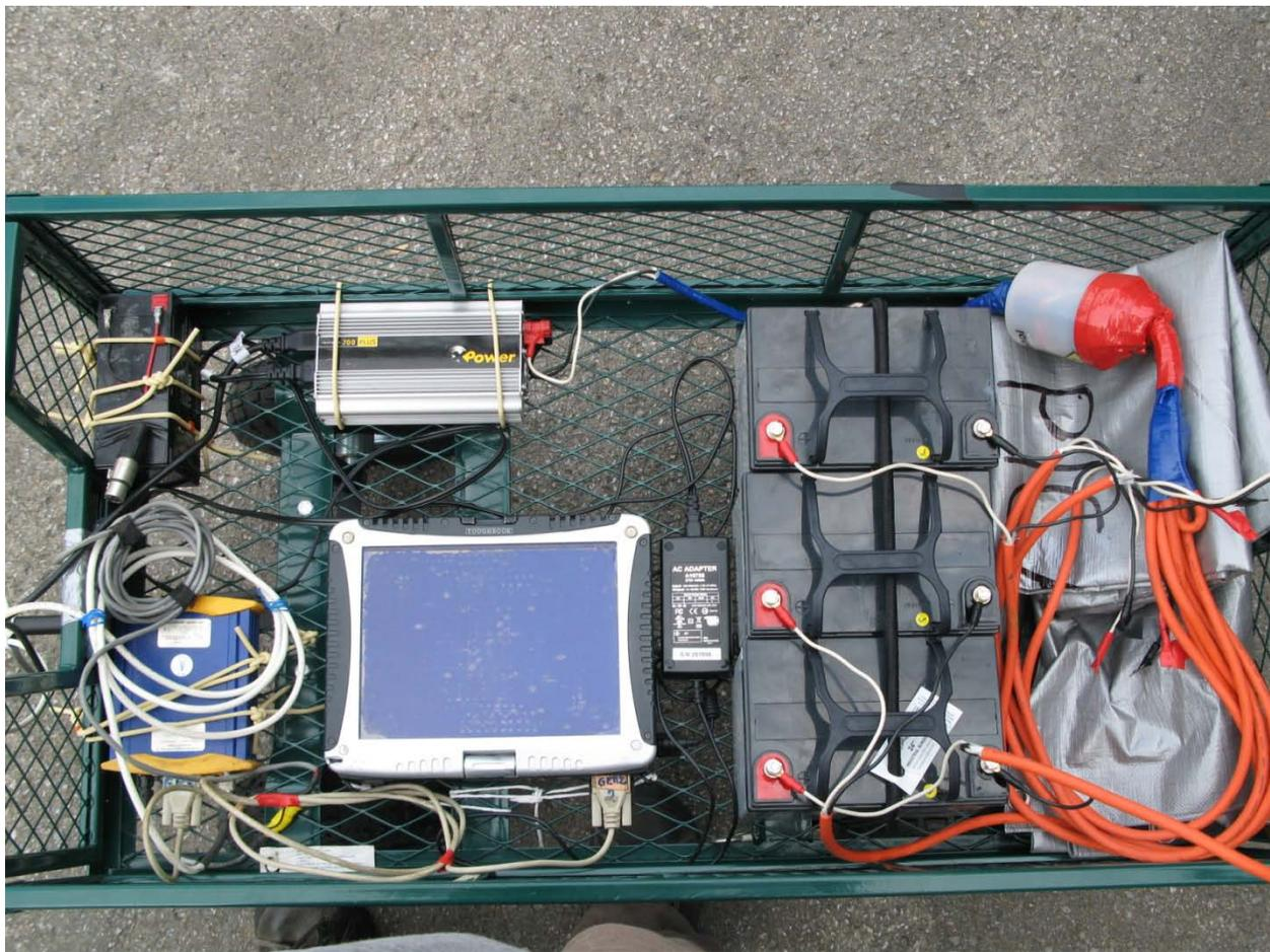
Figure 5. Instrumentation embarquée à l'intérieur du second chariot. L'ordinateur de terrain sert à enregistrer les positions fournies par le GPS à une fréquence de 1Hz.
