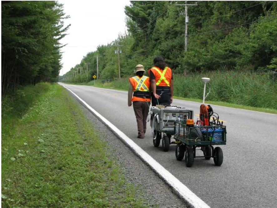
Figure 6. Mesures des concentrations de CO<sub>2</sub> et des ratios isotopiques <sup>13</sup>C/<sup>12</sup>C le long des routes. Deux opérateurs tirent à pied un spectromètre laser à flux continu (premier charriot) alimenté par un set de batteries (second charriot). Un GPS enregistre les positions à une fréquence de 1 Hz, elles sont associées aux mesures de CO<sub>2</sub> sur la base du temps. Un véhicule suiveur (non montré) complète le dispositif.
