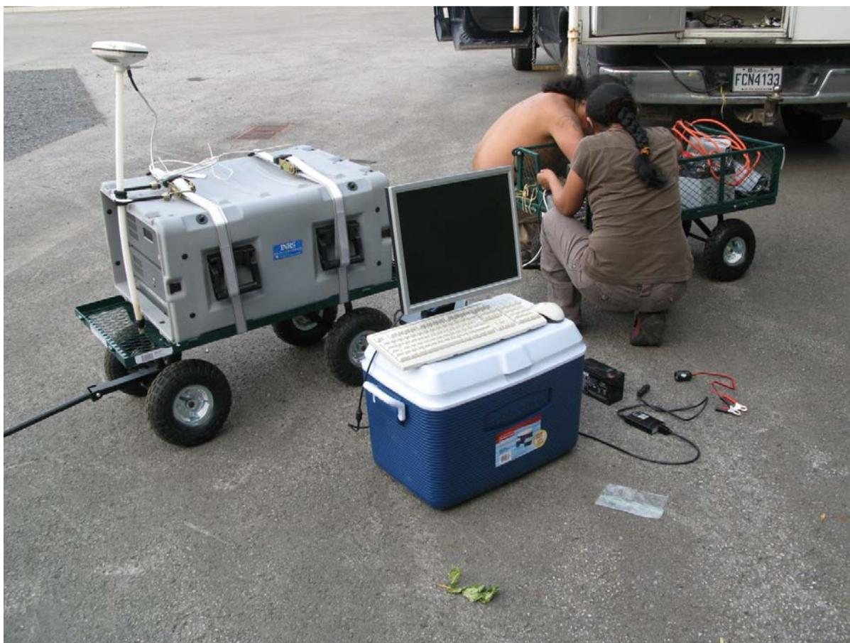
Figure 4. Préparation du spectromètre laser pour le levé de terrain.
