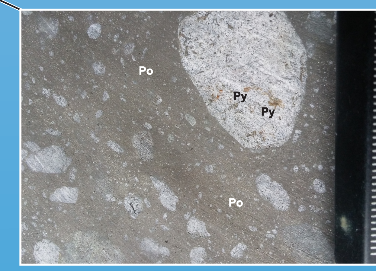
Fig. 15. Lentille de sulfures massifs contenant de l'or. La pyrrhotite (Po) entoure des fragments siliceux arrondis contenant de la pyrite (Py). (16-SG-3503, tranche sciée)
