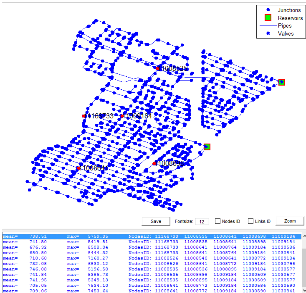
Figure 11 : Exemple du résultat du placement des détecteurs lors d'un test de 30 % des scénarios de contamination
