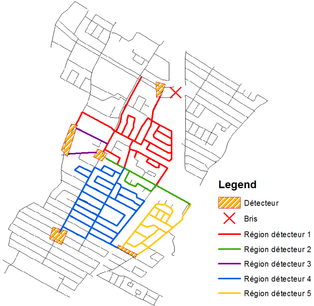
Figure 21 : Impact du bris de la conduite 11128401 sur la détection à 10 h
