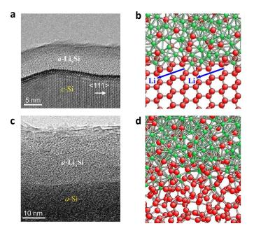
**Figure I.13**. Mécanisme de lithiation cœur-coquille du silicium cristallin (a et b) et amorphe (c et d). (a et c) Images MET haute résolution de l'interface entre c-Si et a-Li<sub>x</sub>Si. (b et d) Schémas représentatifs de la structure atomique à l'interface réalisés par simulation de dynamique moléculaire.**[54]**
