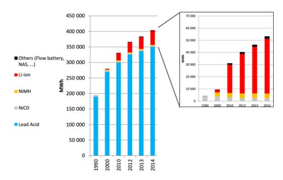
**Figure 1.4** Evolution en énergie du marché mondial des différentes technologies de batteries de 1990 à 2014.**[6]**
