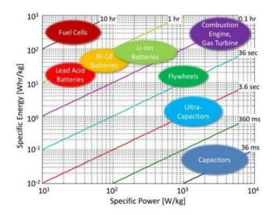
Figure 1.2 Diagramme de Ragonne des différentes technologies de stockage électrochimique d'énergie, comparées au volant d'inertie et au moteur thermique. Les lignes diagonales représentent des temps de décharge constants.[4]
