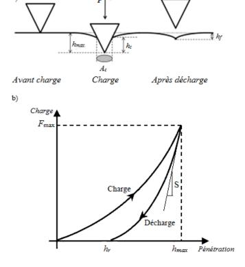
**Figure II.10** a) description du principe de l'indentation et b) exemple type d'une courbe de charge-décharge.
