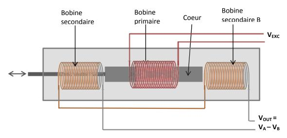
Figure II.8 Schéma de fonctionnement d'un capteur LVDT.
