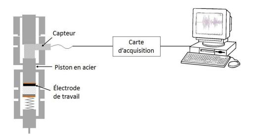
Figure II.7 Schéma du montage de mesure d'émission acoustique.
