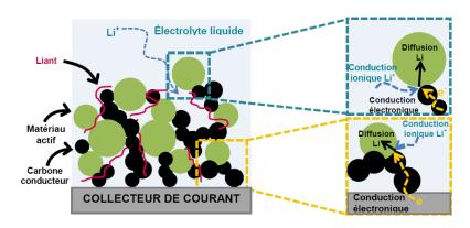
Figure I.18 Schéma d'une électrode composite.[11]
