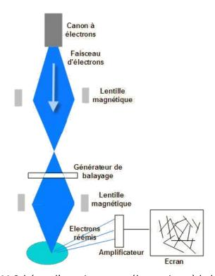
Figure II.11 Schéma d'un microscope électronique à balayage.
