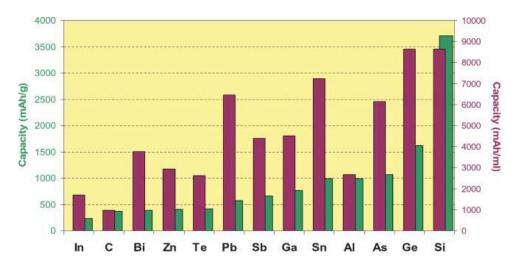
Figure 1.9 Capacités massique (en vert, à gauche) et volumique\* (en violet, à droite) pour le graphite et quelques matériaux d'alliage.[35]
