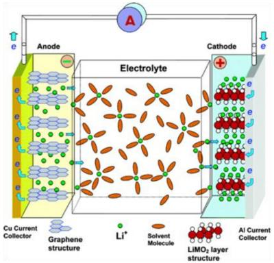
Figure I.5 Schéma du fonctionnement d'une batterie Li-ion lors de la décharge, avec du graphite comme matériau d'électrode négative et LiMO<sub>2</sub> comme matériau d'électrode positive (avec M=Co, Mn,...).
