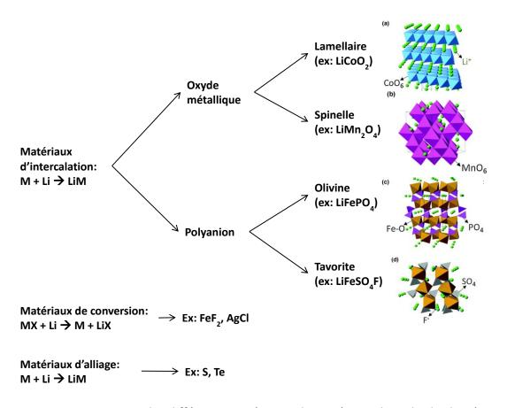
**Figure I.7** Diagramme des différentes catégories de matériaux de cathode classés d'après leur mécanisme de lithiation et structure cristallographique **[16]**.
