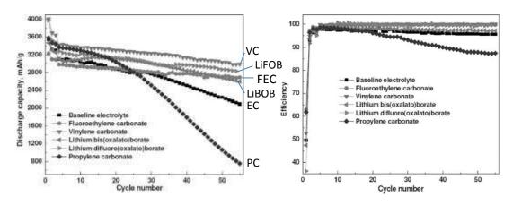
Figure I.20. Tenue au cyclage et efficacité coulombique de films mince de Si avec  $1MLiPF_6$  dans PC/EC/DMC ou EC/DMC/DEC avec 3 wt% FEC, 5 wt% VC, 5 wt% LiBOB ou 1 wt% LiFOB.[39]
