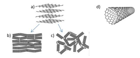
**Figure I.8** Structures cristallines du carbone : a) graphite sous forme b) ordonnée et c) désordonnée, et d) nanotube de carbone.
