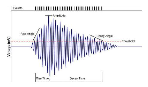
Figure II.4. Schéma d'une salve et des paramètres qui la caractérisent
