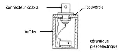
Figure II.3 Schéma d'un capteur piézoélectrique [9].
