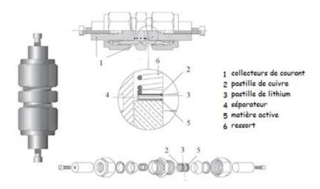
Figure II.1 Schéma de la cellule Swagelok.
