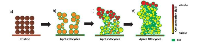
**Figure I.16.** Schéma illustrant la dégradation a) d'une électrode composite, après b) 10, c) 50 et d) 100 cycles. **[42]**
