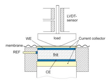
Figure II.8 Schéma de la cellule de dilatométrie électrochimique.
