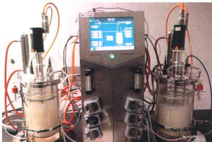
Figure 4- Fermenteurs BioStat B Plus de 5L avec leur panneau de contrôle
