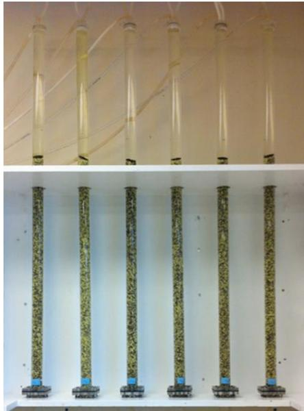
**Figure 3–11** Colonnes de type P en configuration mélangée avec différentes concentrations initiales en nitrates (10, 20, 30, 40, 50 et 60 mg NO<sub>3</sub>-N/L)
