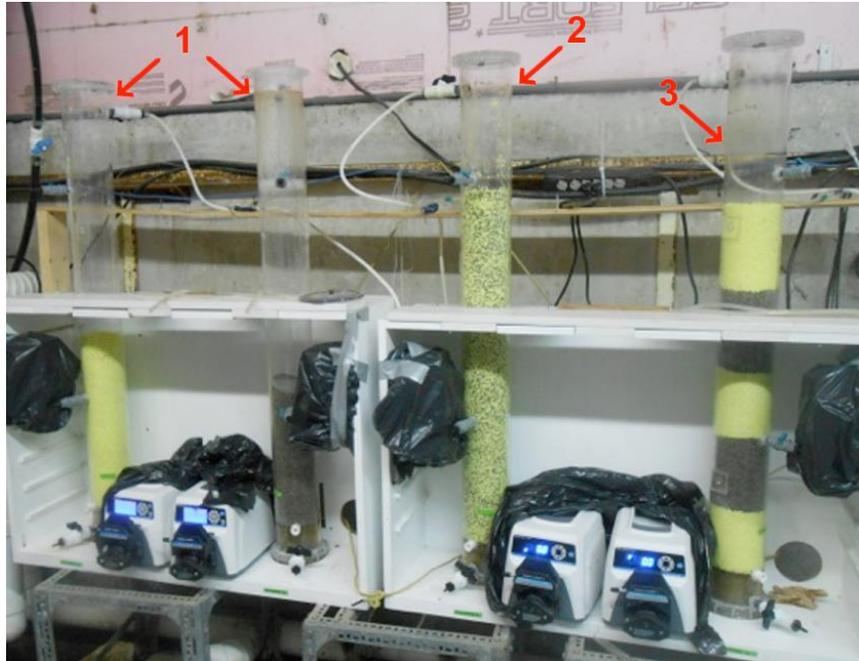
**Figure 3-10 Fonctionnement des bioréacteurs pilotes en mode continu, au TRH optimal (1,5 h) et selon trois configurations différentes: (1) séparée, (2) mélangée et (3) en couches superposées**
