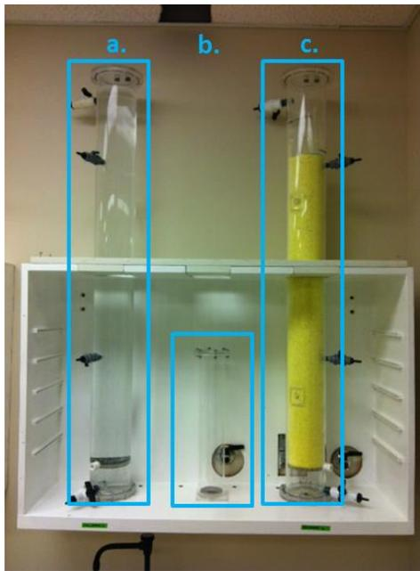
Figure 3-1 Colonnes de type G : (a) et (c) et colonnes de type M : (b) utilisées pour les essais de dénitrification autotrophe et de neutralisation, respectivement.
