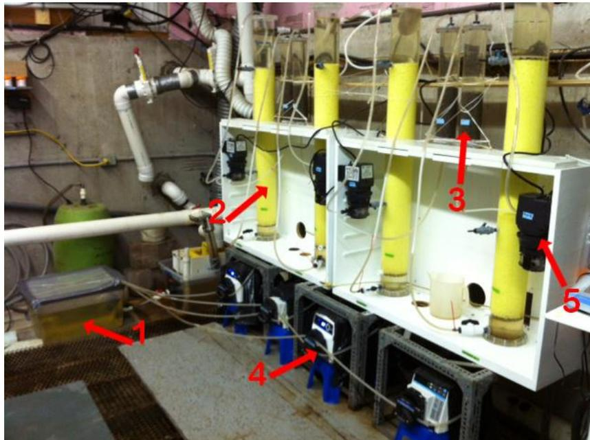
**Figure 3–6** Bioréacteurs pilotes de dénitrification opérés en mode continu à la SEB : (1) Bac de pompage, (2) Colonne de soufre, (3) Colonne de calcaire, (4) Pompe péristaltique d'alimentation  $P_1$  et (5) Pompe de recirculation  $P_2$
