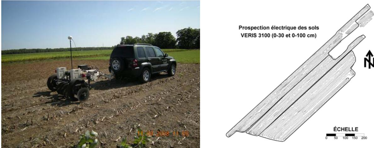
**Figure 10 :** Illustration de la procédure de mesure de la conductivité électrique apparente des sols avec l'appareil VERIS 3100 jumelée à un DGPS.
