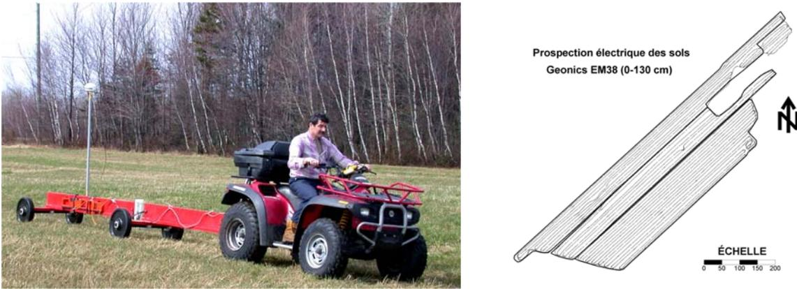
**Figure 9 :** Illustration de la procédure de mesure de la conductivité électrique apparente des sols avec le Geonics EM-38 jumelé à un DGPS.
