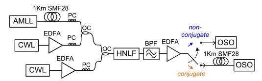
Figure 11 – Montage expérimental de la conversion en longueur d'onde du signal reposant sur le XPM pour des signaux à enveloppe complexe. AMLL : laser en mode actif bloqué; PC, contrôleur de polarisation; CWL, laser continue; EDFA, amplificateur sur fibre dopée à l'Erbium; OSO, oscilloscope optique à prélèvement; OC, coupleur optique; SMF, fibre monomode.
