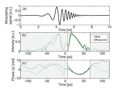
Figure 14 – Impulsion triangulaire asymétrique avec une phase parabolique : (a) hologramme spectrale  $H_{hc}(t)$ ; (b) intensité temporelle du signal de sortie; et (c) phase temporelle du signal de sortie : ciblée (ligne bleue en pointillé) et mesurée (ligne verte pleine).
