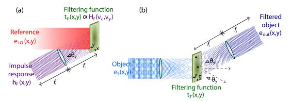
Figure 2 – Filtre de Vander-Lugt : (a) Enregistrement de l'hologramme, qui contient l'information de la fonction de transfert complexe du filtre et (b) procédé de filtrage de signaux basé sur la concaténation de deux systèmes de transformés de Fourier.
