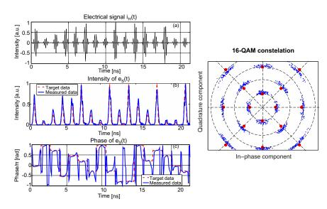
Figure 7 – Flux de données optiques, 1024 symboles au format 16-QAM. (a) Une partie de l'hologramme temporel conçu numériquement généré par GOP; Profils (b) d'intensité et (c) de phase du signal optique à enveloppe complexe généré (ligne bleue) et le flux de donnée visé (ligne rouge); (d) Constellation du flux de donnée généré (points bleu) et constellation idéale (points rouge) d'un signal 16-QAM.
