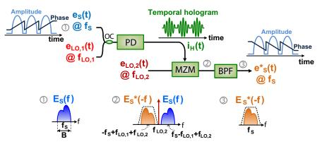
Figure 8 – Montage utilisé pour générer CTP basé sur le concept de l'holographie temporelle.
