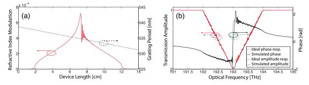
Figure 16 – (a) Profiles d'apodisation (ligne pleine rouge) et de période (ligne en pointillé noir); (b) amplitude (ligne bleue en pointillé) et la phase (ligne verte en pointillé) de la réponse spectrale en transmission voulue comparée à l'amplitude (ligne rouge pleine) et la phase (ligne noire solide) de la réponse spectrale en transmission avec les contraintes de fabrication.
