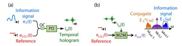
Figure 3 – (a) Génération d'hologramme temporel; (b) Récupération de l'information complexe. OC, coupleur optique; PD, photo détecteur; MZM, Modulateur Mach-Zehnder. Seule l'enveloppe complexe du signal temporel est représentée.
