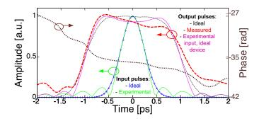
Figure 20 – Impulsion idéale en entrée (ligne bleue en croix) ; impulsion expérimentale en entrée (ligne verte en pointillé) ; impulsion idéale en sortie (ligne noire en point) ; l'impulsion rectangulaire en sortie mesurée (ligne rouge en tiret) ; impulsion en sortie obtenue numériquement d'après l'impulsion en entrée expérimentale et la réponse idéale du réseau (ligne violette pleine) ; phase de l'impulsion mesurée (ligne pointillée).
