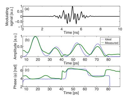
Figure 15 – Code 4-bit 16-QAM : (a) hologramme spectral  $H_{hc}(t)$ ; (b) amplitude temporelle du signal de sortie, seulement la partie droite du signal de sortie est présentée, correspondant de l'impulsion cible mise en forme; (c) phase temporel du signal de sortie : ciblée (ligne bleue en pointillé) et mesurée (ligne verte pleine).
