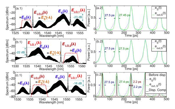
Figure 12 – (a) Décalage négatif de  $e_S(t)$ ; (b) décalage positif de  $e_S(t)$ ; (c) décalage négatif de  $e_S^*(t)$ ; a-c (1) Spectre après FOHNL; a-b (2) signal temporel après FOPB (ligne verte) vs. signal d'entrée (ligne en pointillé bleue); c (2) signal de sortie du LMAB (ligne rouge) et après compensation de la dispersion (ligne noire).
