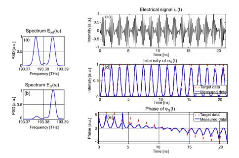
Figure 6 – Séquence de 16 impulsions gaussiennes avec une phase quadratique différentes entre elles. (a) Densité de puissance spectrale (PSD) du signal optique après la modulation d'intensité; (b) PSD du signal optique après le filtre; (c) Signal électrique généré par GOP; (d) Intensité de l'onde à enveloppe complexe générée (en bleu) et l'intensité ciblée (rouge); (e) Phase de l'onde générée (en bleu) et la phase ciblée (rouge).
