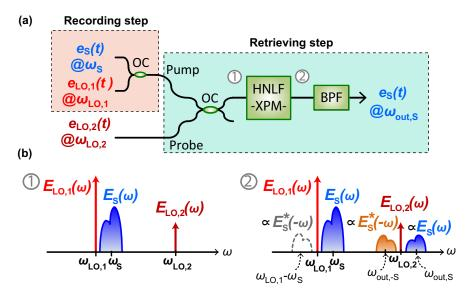
Figure 4 - (a) Schéma de production d'holographie temporelle basé sur XPM. Dans ce cas ,les procédés d'enregistrement et d'extraction sont concaténés; (b) Spectre avant et après propagation dans la FOHNL (HNLF).
