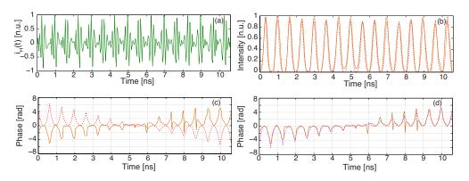
Figure 9 – (a) Hologramme temporel du signal d'entré après détection; (b) Intensité détectée du signal conjugué (ligne pleine orange), comparée avec le profil d'intensité du signal d'entrée (ligne en pointillé rouge); (c) Phase détectée du signal conjugué (ligne pleine orange) et phase du signal d'entrée (ligne en pointillé rouge), et (d) Comparaison entre le signal de sortie détecté (ligne orange pleine) et la phase du signal idéal conjugué en entrée (ligne en pointillé violette).
