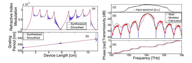
Figure 19 – Profils d'apodisation des RDBF obtenues (a) et période (b) de la synthèse (ligne bleue) et profils lissés adaptés aux contraintes de fabrication, i.e., résolution spatiale  $\geq 1 \text{ mm}$  (ligne rouge); (c) spectre du signal en entrée; (d) transmission et (e) phase de la transmission : idéales (ligne bleue), simulées considérant les contraintes de fabrication (ligne rouge) et mesurées du dispositif fabriqué (ligne noir en pointillé).
