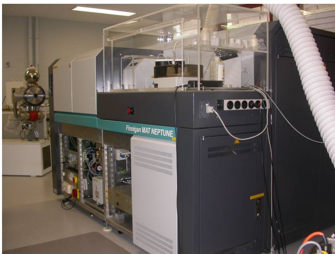
Figure 6. Le Neptune MC-HR-ICP-MS dans le laboratoire de la Research School of Earth Sciences (Australian National University).
