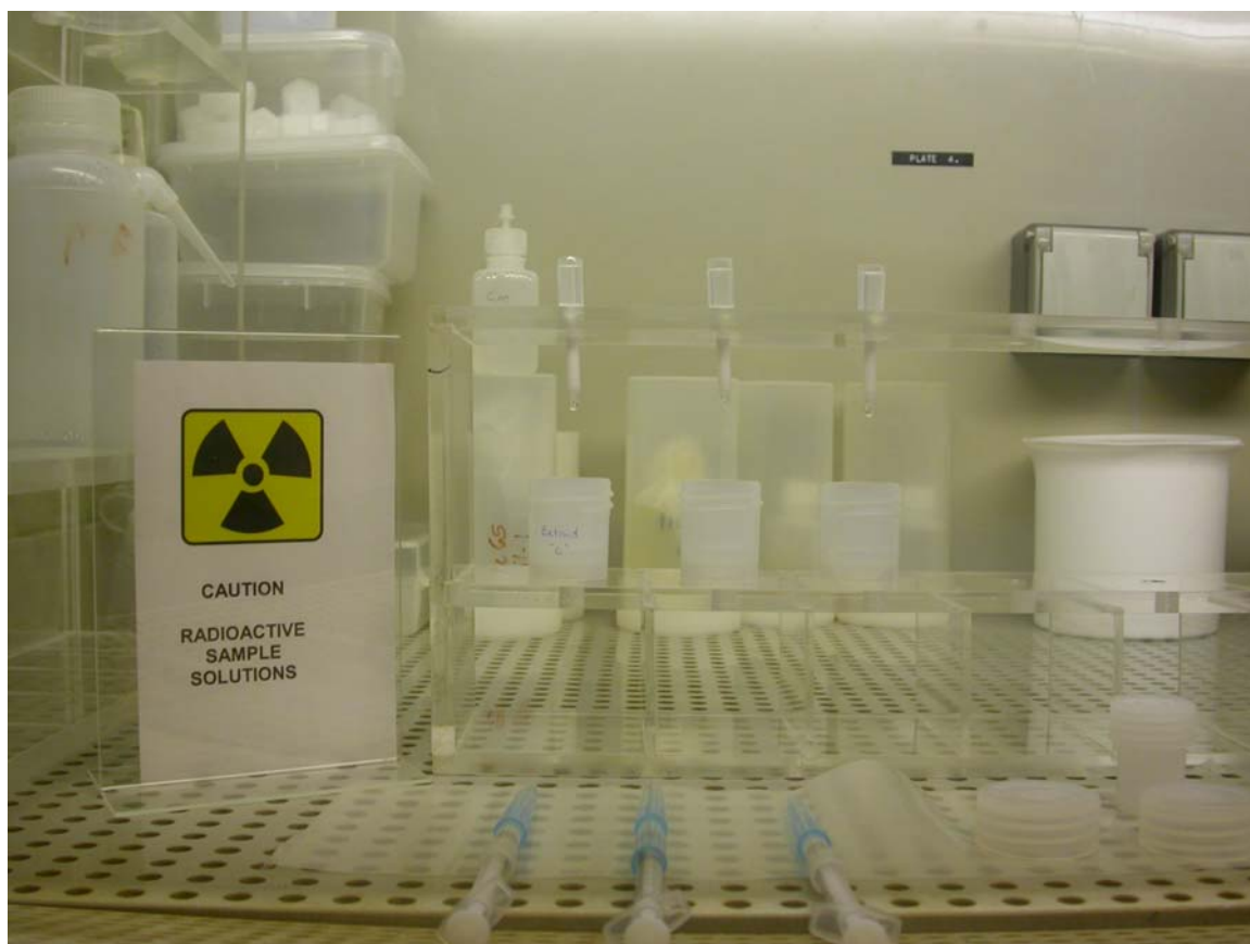
Figure 5. Photo montrant le montage utilisé pour l'extraction chromatographique sur colonnes.
