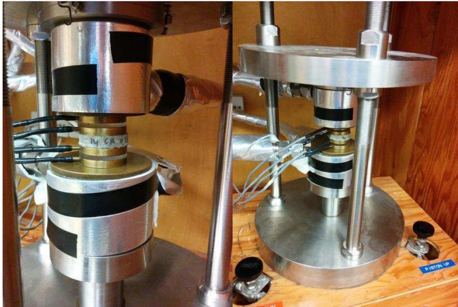
**Figure 3.2: Mesure de la conductivité thermique avec la méthode de la barre divisée, laboratoire de la Commission géologique du Canada au bureau de Calgary.**
