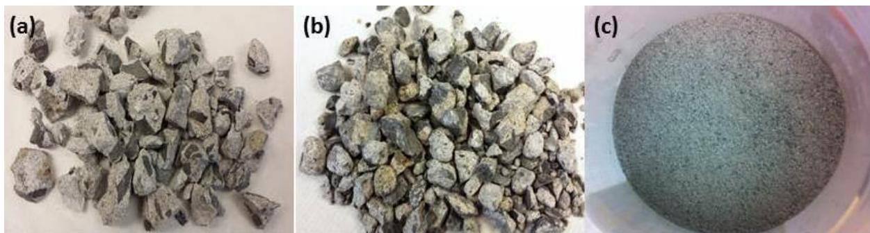
**Figure 1.13 Aspect des matériaux: (a) béton brut concassé en entier, (b) granulats issus du concassage optimisé et de la séparation de la fraction > 2 mm, (c) fraction fine du béton issus du tamisage < 500 µm**
