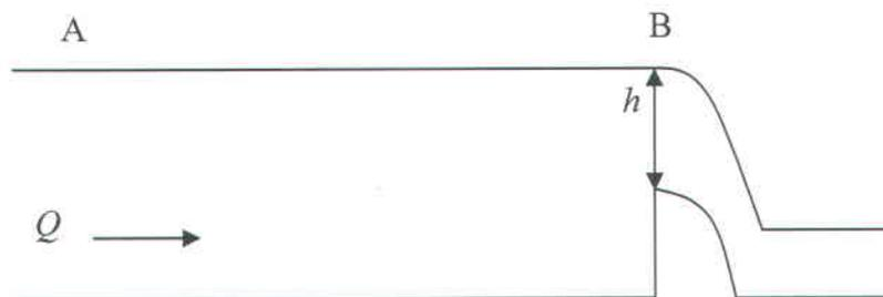
Figure C.1 Écoulement en amont et au droit d'un déversoir
