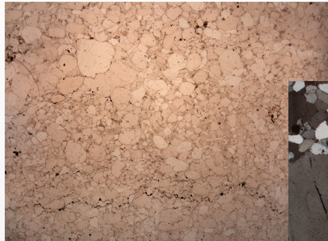
Variation granulométrique entre des laminations successives. Création d'horizon de pression-dissolutions à l'interface de certaines d'entre-elles.
