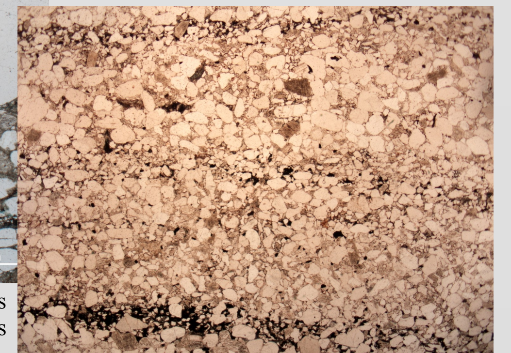
Composition minéralogique variée : quartz, orthose et minéraux opaques. On remarque la variation granulométrique importante entre les laminations.
