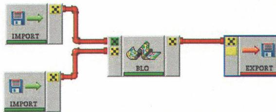
Figure 6.48 : Automatisation de l'application d'un masque sur les zones hors rivière.
