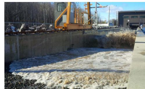
Figure 3. Plage de type sable-gravier-galet reposant dans le canal de 120 mètres de long, 5 mètres de large et 5 mètres de hauteur.
