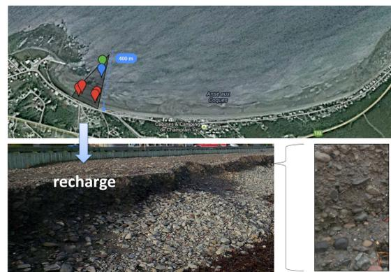
Figure 2. Haut : Plage de Sainte-Luce et emplacement des sondes de pression RBR enterrées (vert et rouge) et de l'ADP (bleu) situé à 80 cm du fond. Bas : Recharge de la plage
