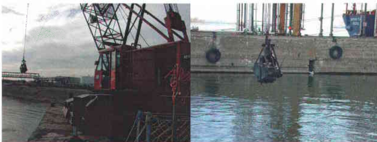
Figure 2: Positionnement de la grue au quai 104 et échantillonnage à l'aide d'un godet (Bergeron et Blackburn, 2001).
