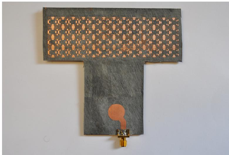
Fig. 10.26. Antenne avec les cellules miniaturisées ( $a=116$ ,  $b=89$ ,  $c=65$ ,  $d=40$ ,  $e=32$  mm).
