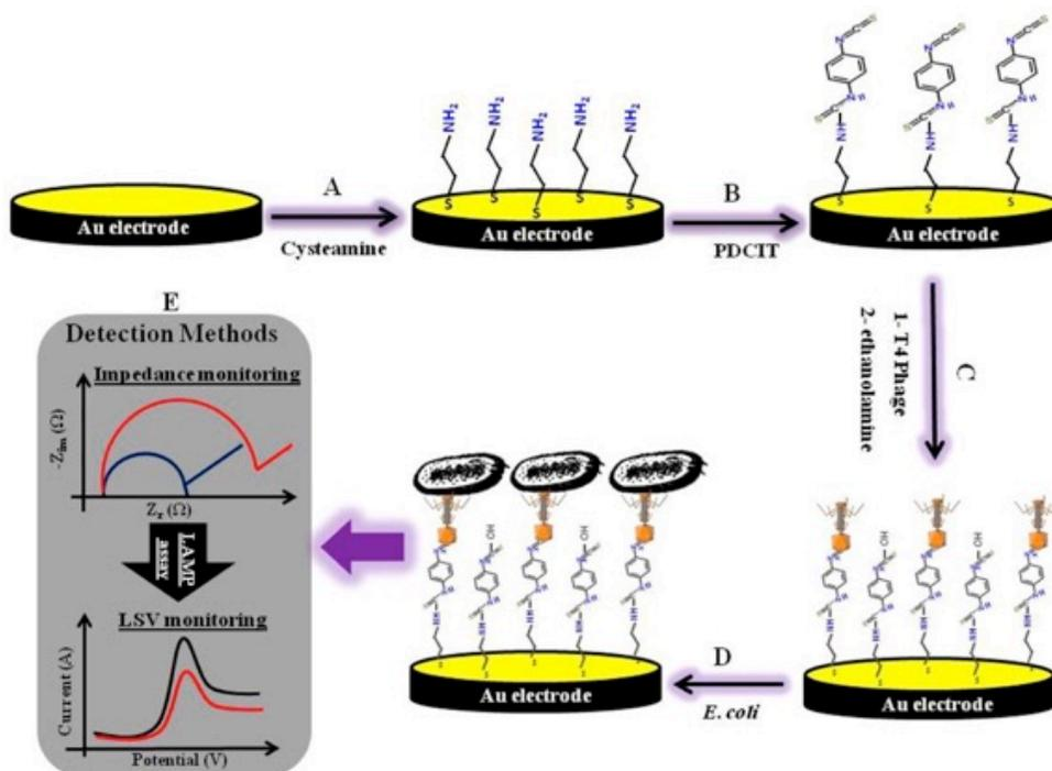
**Fig 6.1** La représentation schématique des biocapteurs bactériophage T4. (A) Montage de la cystéine sur l'électrode. (B) Activation avec du 1,4-dithiocyanate (PDCIT) Agent de réticulation. (C) Immobilisation du phage T4 et le blocage avec de l'éthanol aminé. (D) Capture des cellules de *E. coli*. (E) Procédé de détection de *E. coli* basé sur les double réponse impédimétrique / LAMP.
