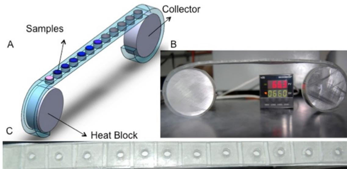
**Fig 4.1** Vue d'ensemble du dispositif de la cassette et de ses composants. (A) Représentation schématique de la cassette. La cassette se compose de deux bobines d'aluminium pour fournir et collecter des échantillons, un dispositif de commande de chaleur et un dispositif de chauffage à température précise pour fournir l'amplification et le substrat flexible, où les chambres sont fabriquées. (B) l'image du substrat flexible. (C) l'image du substrat flexible.
