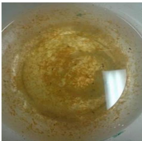
**Figure 4-37** Photographie de la formation des floccs d'hydroxydes de Fe présents dans le surnageant de précipitation à pH = 4,5 après oxydation des ions ferreux en présence de H<sub>2</sub>O<sub>2</sub>
