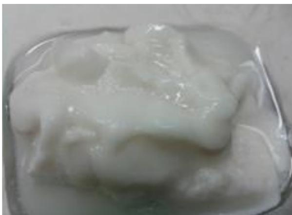
**Figure 4-41** Photographie d'un précipité d'hydroxyde de zinc obtenu après précipitation à pH 7,0 suivie par une séparation S/L par centrifugation du surnageant 1 (facteur de dilution = 1)
