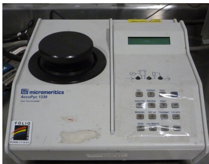
**Figure 3-1 Pycnomètre à hélium (Folio Instruments Inc. Accupyc 1330)**
