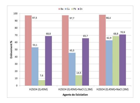
Figure 4-3 Rendements d'enlèvement (%) des métaux obtenus après lixiviation acide en présence d'acide sulfurique ( $[H_2SO_4] = 0,45$  M) et de chlorure de sodium (0 – 1,5 et 3 M), avec DP = 15%, T = 25°C, 1 étape de lixiviation de 4 h et 1 étape de rinçage de 15 Min de la fraction < 125  $\mu$ m de sol CMR28
