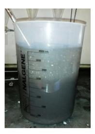
Figure 3-2 Montage de mise à l'échelle du procédé de lixiviation acide et basique de la fraction < 125 μm de sol CMR28
