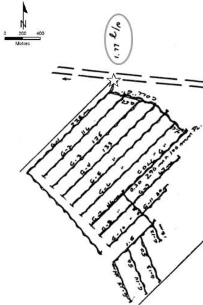
Figure VI.2 : Plan du réseau de drainage dans la parcelle NF106-1 et valeur (encerclée ci-haut) de coefficient de drainage utilisée dans la modélisation avec DRAINMOD.
