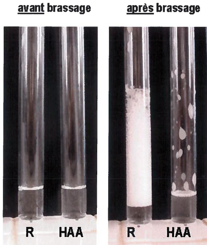
Figure 3.3 - Test de moussage des rhamnolipides et des dilipides. Solutions de 2 ml de 250 ppm de rhamnolipides et de dilipides avant et après brassage pendant 1 minute. La hauteur de la mousse formée par les rhamnolipides (R) est de 6.7 cm alors que celle formée par les dilipides (HAA) est de 0.2 cm.
