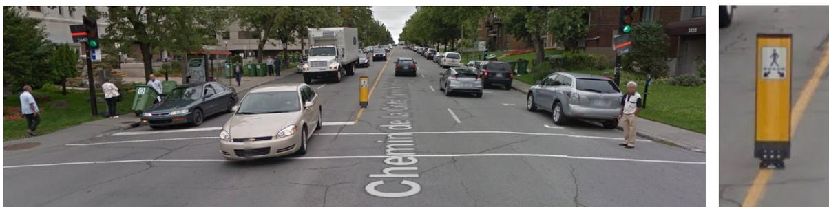
Figure 4.18 : Exemple de bollard central sur le chemin de la Côte-Ste-Catherine à l'angle de la rue Légaré (Source : Google StreetView 2011)
